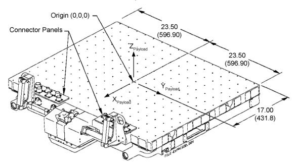
FIGURE 4.3.1-1 CEPA ISOMETRIC VIEW AND COORDINATE SYSTEM
