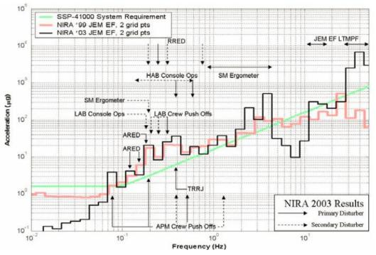
FIGURE 3.2.1-2 TYPICAL MICROGRAVITY ENVIRONMENT FOR JEM-EF
