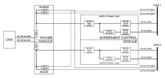
FIGURE 4.1.5-2 ISS TO EXPA POWER BLOCK DIAGRAM
