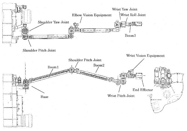
FIGURE 4.2.2-1 JEM-EF MA CONFIGURATION
