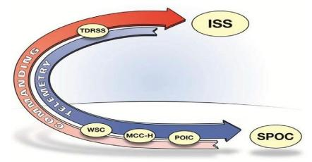
FIGURE 5.2.1-1 TYPICAL COMMAND AND TELEMETRY PATH
